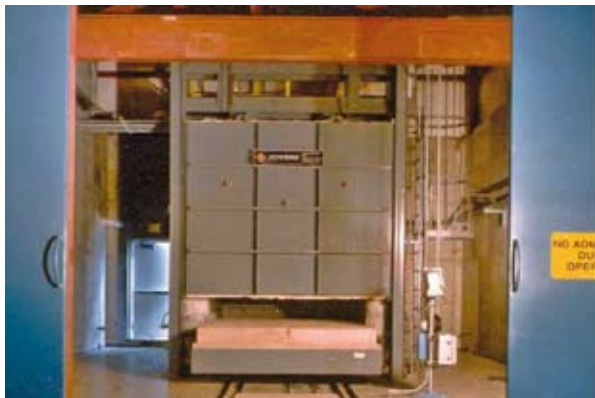
Abbildung 4.4: Der Herdwagenofen mit halb geöffneten Türen
