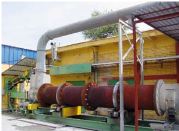
Abbildung 4.1: Außenansicht eines Drehofens (Copyright NAMSA)
