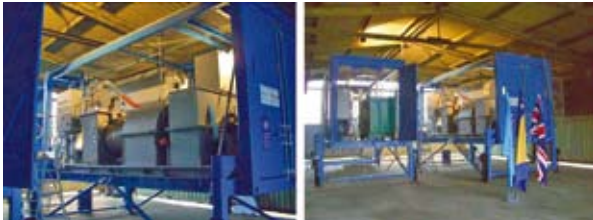
Abbildung 4.2: Das von UNDP in Bosnien eingesetzte containerisierte Munitionszerstörungssystem
