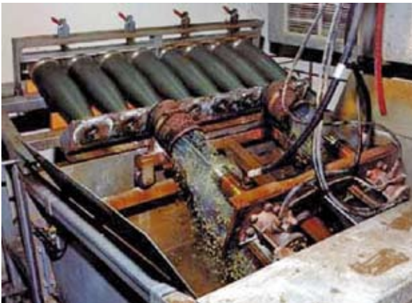
Abbildung 6.3: Auswaschung von 155-mm-Granaten mittels Wasserstrahl
